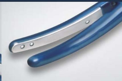
Die in eine Branche des Instruments eingebrachten Keramikstifte gewähren einen definierten Abstand zwischen den beiden Branchen über deren gesamte Länge und vermeiden damit einen Kurzschluss. Außerdem wird dadurch ein Herausrutschen des Gewebes verhindert.
